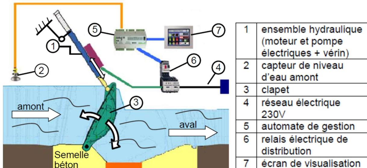
L'ensemble hydraulique, alimenté par le réseau électrique, pousse ou tire le clapet.
